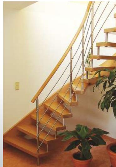
Bolzentreppe Typ DW5B, viertelgewandelt, Buche ungedämpft, Stufendicke 60 mm, Edelstahl Rellingeländer und Handlaufkrümmung Ø 50 mm
