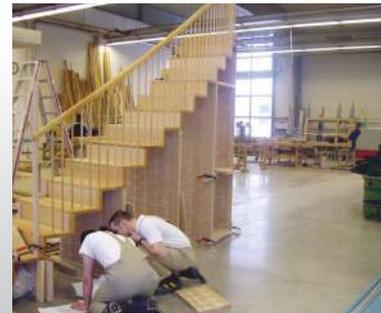
Faltwerktrappe in der Fertigung
